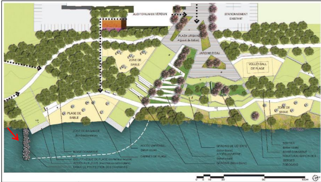
Figure 2. Projet d'aménagement initial de la plage de Verdun et digue de protection perpendiculaire au courant du chenal de l'île-des-Sœurs indiquée par une flèche rouge sur la carte
